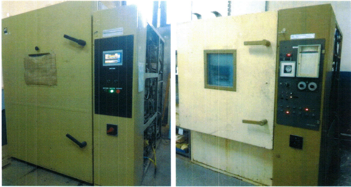
Рисунок 3 – Кліматичні камери для проведення циклічних кліматичних впливів
